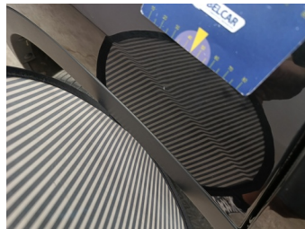
Vleugel RA - Vleugel RA - Kras en Deuk - Herstellen en spuiten
