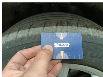
Wiel RV - Band RV - Versleten - Vervangen
