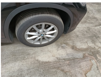
Wiel RV - Band RV - Versleten - Vervangen
