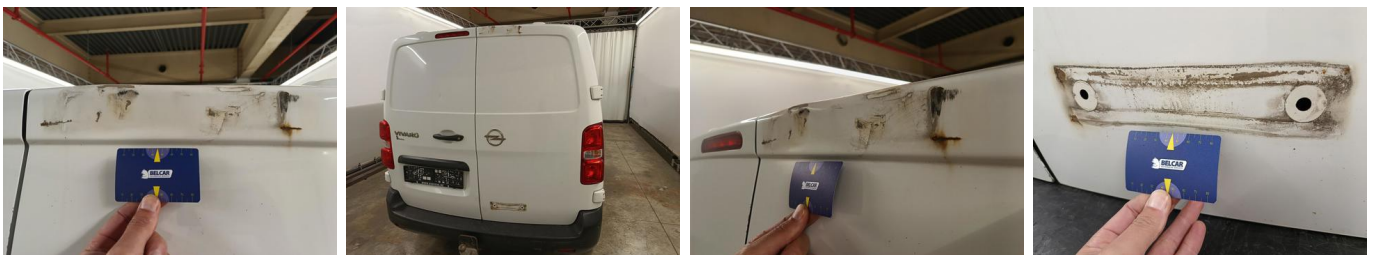
Koffer - Laaddeur RA - Kras en Deuk - Vervangen en spuiten
