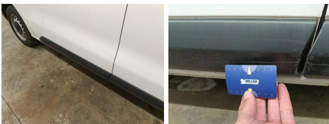
Deur RA - Stootlijst RR - Kras - Vervangen
