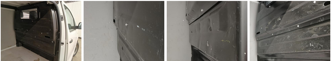
INT achteraan - Scheidingswand - Kras en Deuk - Vervangen
