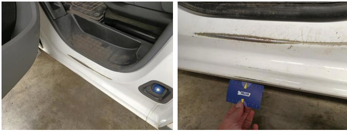
Onderkant L - Drempel L - Kras - Spotrepair
