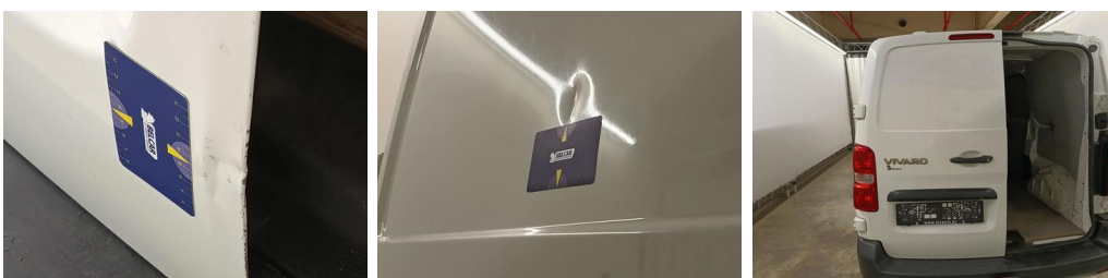
Koffer - Laaddeur LA - Kras en Deuk - Herstellen en spuiten
