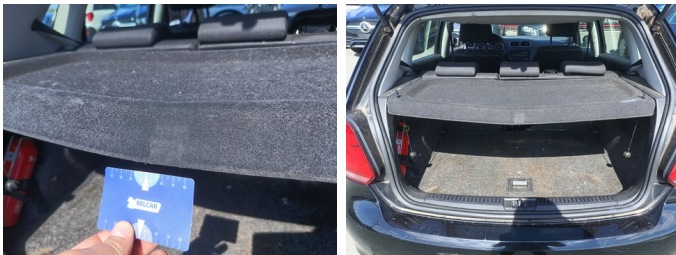
INT achteraan - Hoedenplank - Vervormd/geforceerd - Vervangen
