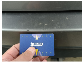
Koffer - Kofferdeksel - Kras en Deuk - Herstellen en spuiten
