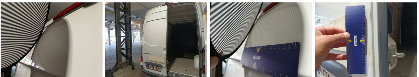
Koffer - Laaddeur LA - Kras en Deuk - Herstellen en spuiten
