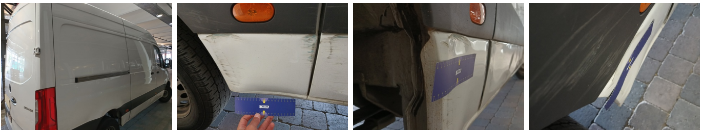
Vleugel RA - Vleugel RA - Kras en Deuk - Herstellen en spuiten
