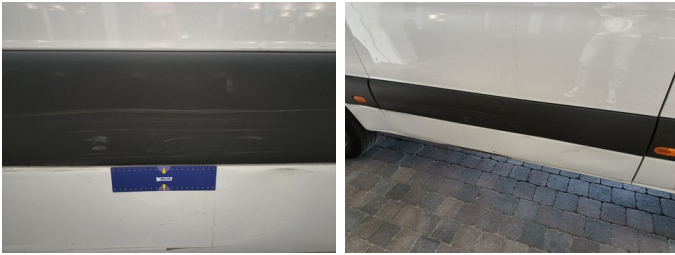
Deur RA - Stootlijst RR - Kras - Vervangen
