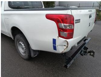
Vleugel LA - Vleugel LA - Kras en Deuk - Vervangen en spuiten
