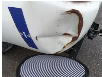
Vleugel LA - Vleugel LA - Kras en Deuk - Vervangen en spuiten
