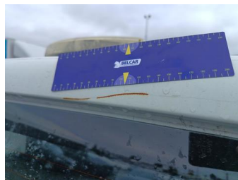
Koffer - Kofferdeksel - Corrosie / roest - Herstellen en spuiten
