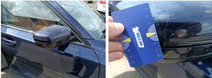
Spiegel R - Spiegelkap R gespoten - Gebarsten - Vervangen en spuiten
