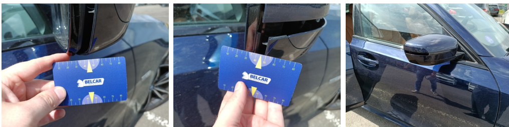
Spiegel R - Spiegelkap R niet-gespoten - Vervormd/geforceerd - Vervangen
