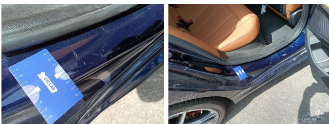
Onderkant R - Drempel INT RA - Kras - Spuiten
