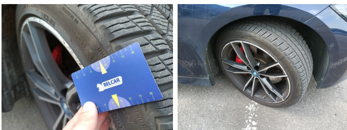
Wiel RV - Band RV - Vervormd/geforceerd - Vervangen
