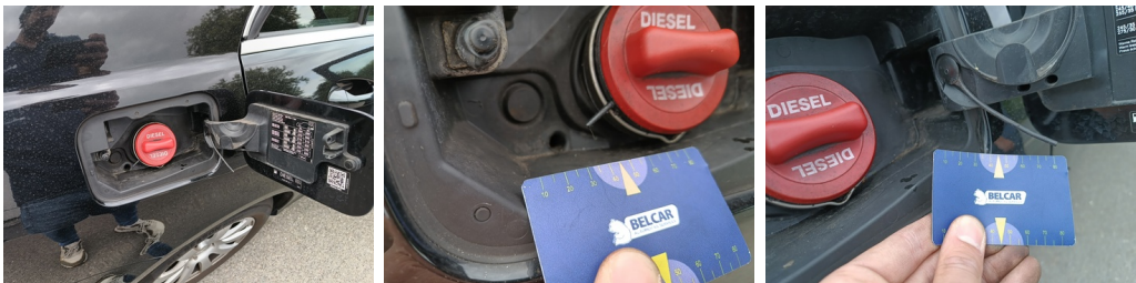
Vleugel RA - Brandstofklep RA - N comf / defect - Vervangen
