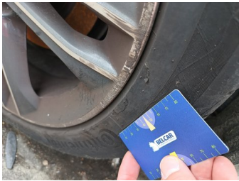
Wiel RA - Band RA - Scheur - Vervangen
