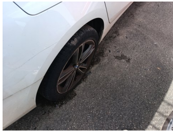
Wiel RA - Band RA - Scheur - Vervangen
