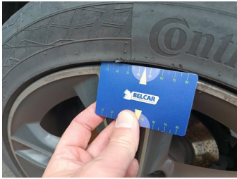
Wiel LA - Band LA - Scheur - Vervangen
