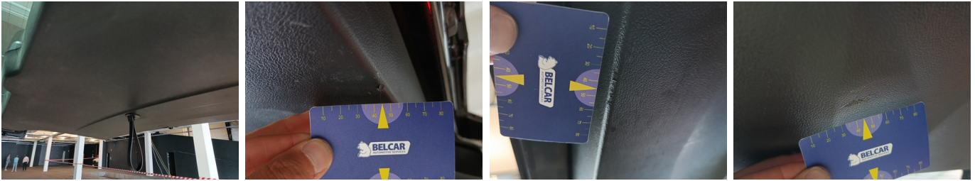
INT achteraan - Bekleding kofferdeksel - Kras - Structuur
