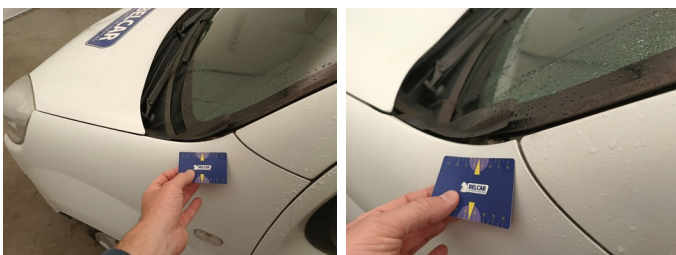
Voorruit - Sierlijst / Rubber L - Slecht geplaatst - Vervangen
