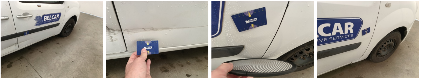
Deur RV - Deur RV - Kras en Deuk - Herstellen en spuiten
