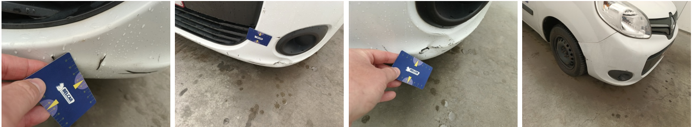
Bumper voor - Bumper vooraan - Gebarsten - Vervangen en spuiten
