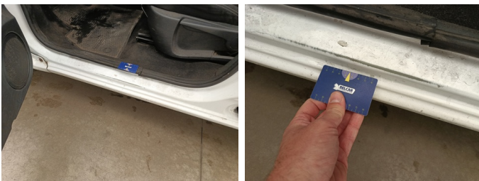
Onderkant L - Drempel L - Kras - Spotrepair
