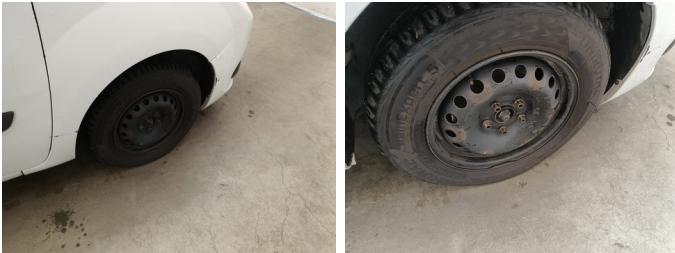
Wiel RV - Wieldeksel RV - Ontbreekt - Vervangen
