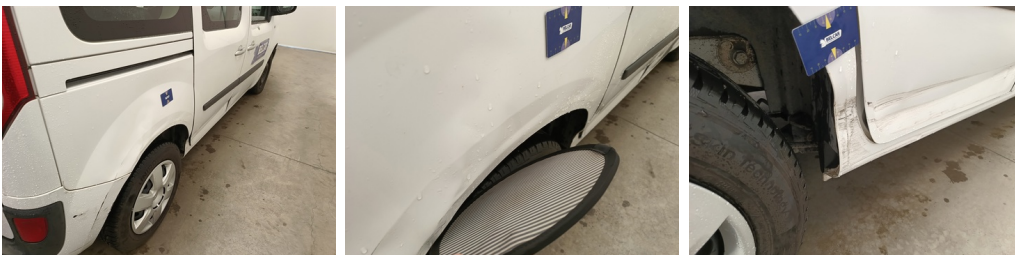
Vleugel RA - Vleugel RA - Kras en Deuk - Herstellen en spuiten
