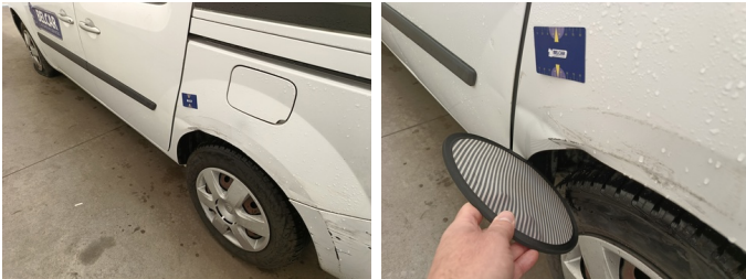
Vleugel LA - Vleugel LA - Kras en Deuk - Herstellen en spuiten
