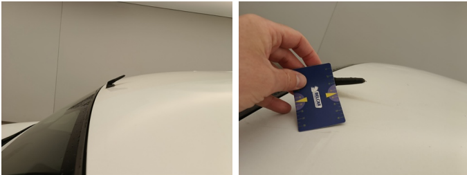
Boven - Antenne - Gebarsten - Vervangen
