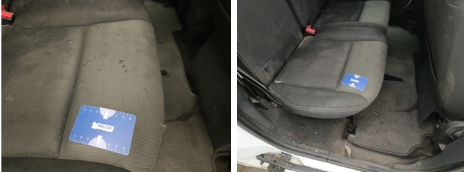
Zetels - Bekleding zit RA - Scheur - Vervangen
