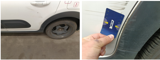
Onderkant L - Afdekking drempel L - Kras - Structuur
