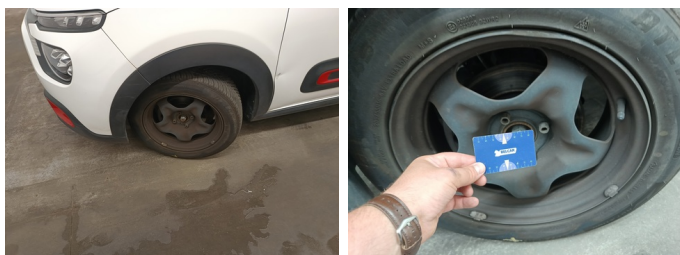
Wiel LV - Wieldeksel LV - Ontbreekt - Vervangen
