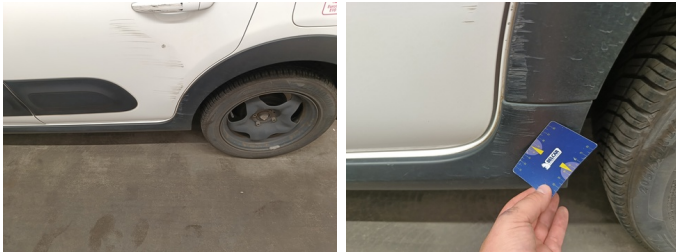
Onderkant L - Afdekking drempel L - Kras - Structuur
