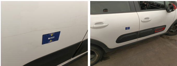
Deur RA - Deur RA - Kras - Spuiten
