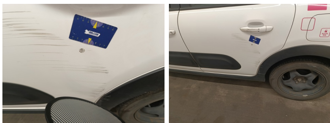
Deur LA - Deur LA - Kras en Deuk - Herstellen en spuiten
