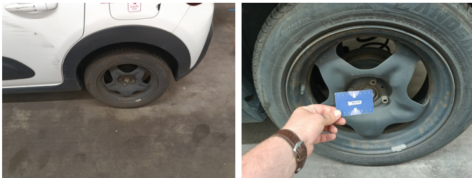
Wiel LA - Wieldeksel LA - Ontbreekt - Vervangen
