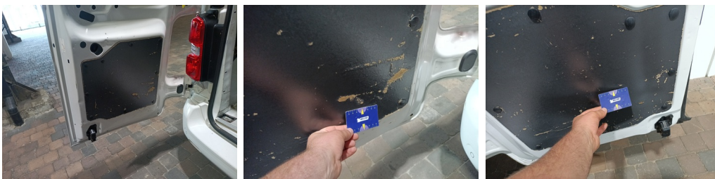
INT achteraan - Bekleding kofferdeksel - Kras - Vervangen
