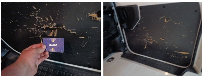
INT Vooraan / Midden - Deurpaneel RA - Gebarsten - Vervangen
