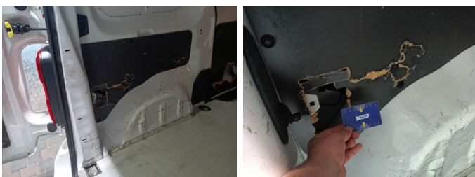
INT achteraan - Bekleding koffer L - Gat - Vervangen
