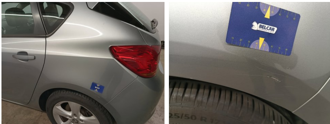
Bumper Achter - Bumper achter - Gebarsten - Vervangen en spuiten
