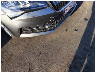
Bumper voor - Bumper vooraan - Kras en Deuk - Herstellen en spuiten
