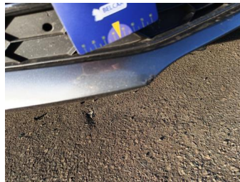
Bumper voor - Bumper vooraan - Kras en Deuk - Herstellen en spuiten
