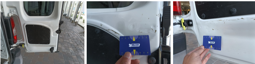
Koffer - Laaddeur RA - Kras en Deuk - Herstellen en spuiten
