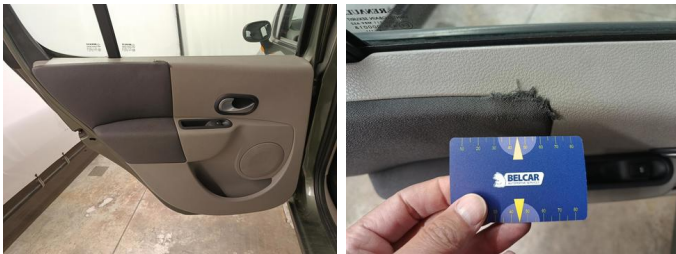
INT Vooraan / Midden - Deurpaneel LA - Scheur - Vervangen
