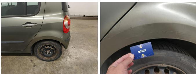
Vleugel LA - Vleugel LA - Slecht hersteld - Herstellen en spuiten
