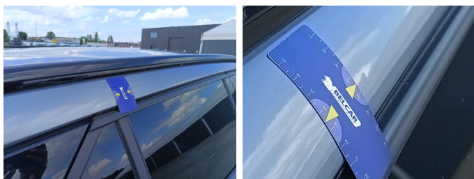
Boven - Dakstijl R - Deuk - Spotrepair
