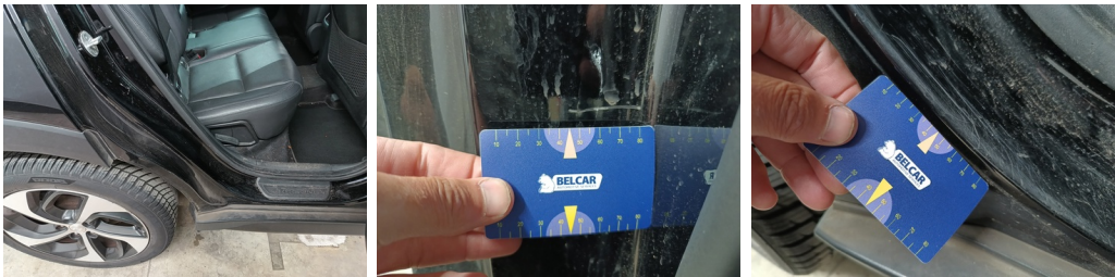
Onderkant R - Drempel R - Kras - Spotrepair
