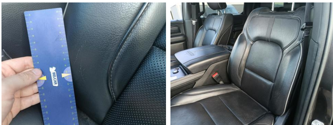
Zetels - Bekleding rug LV - Kras - Vervangen
