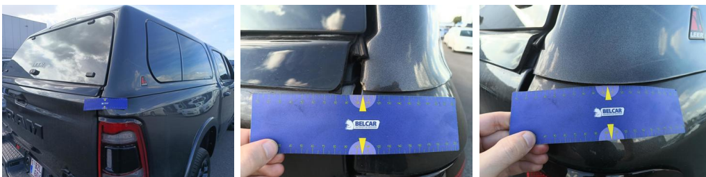
Vleugel RA - Vleugel RA - Gebarsten - Vervangen en spuiten
