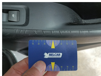
INT Vooraan / Midden - Deurpaneel RA - Kras - Vervangen
