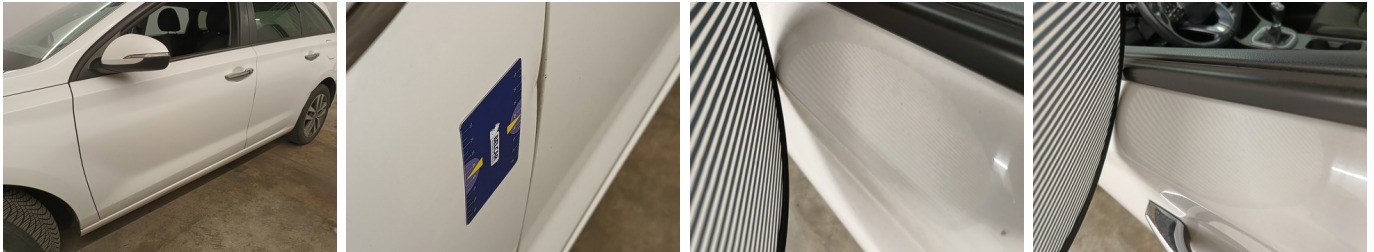
Deur LV - Deur LV - Deuk - Herstellen en spuiten
