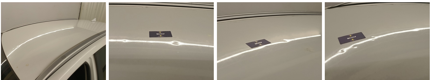
Boven - Dak - Hagelschade - Herstellen en spuiten
