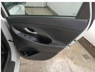
INT Vooraan / Midden - Deurpaneel RA - Kras - Vervangen
