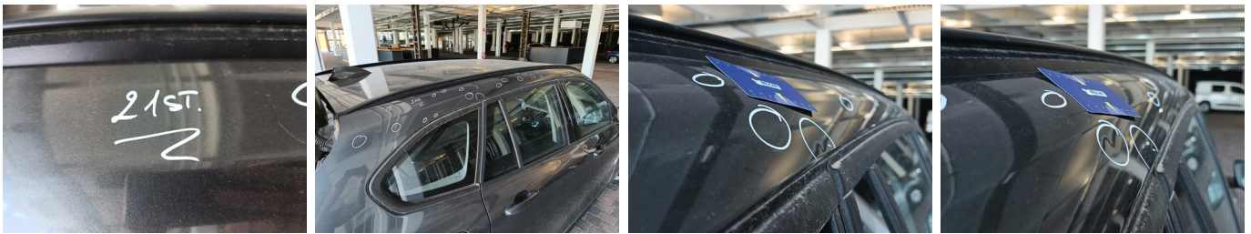
Boven - Dakstijl R - Hagelschade - Herstellen en spuiten
