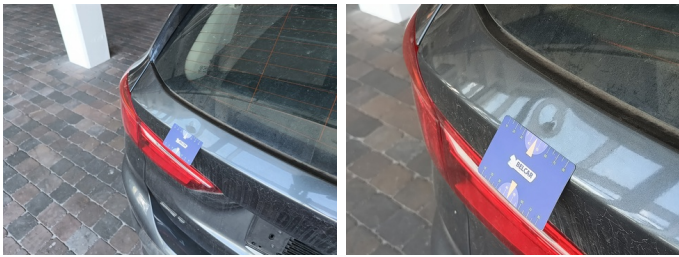
Koffer - Kofferdeksel - Hagelschade - PDR
