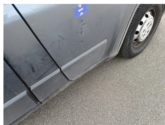
Deur RV - Stootlijst RV - Kras - Vervangen
