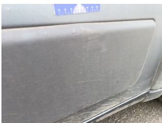
Deur RV - Stootlijst RV - Kras - Vervangen
