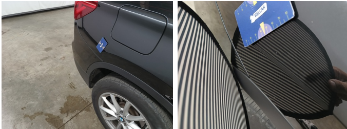
Vleugel RA - Vleugel RA - Kras en Deuk - Herstellen en spuiten
