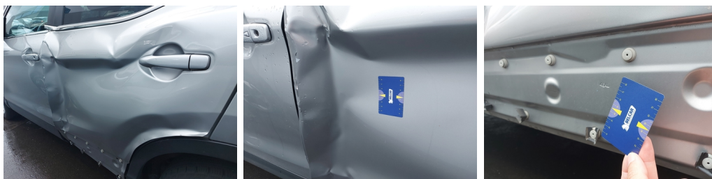
Deur LA - Deur LA - Kras en Deuk - Vervangen en spuiten
