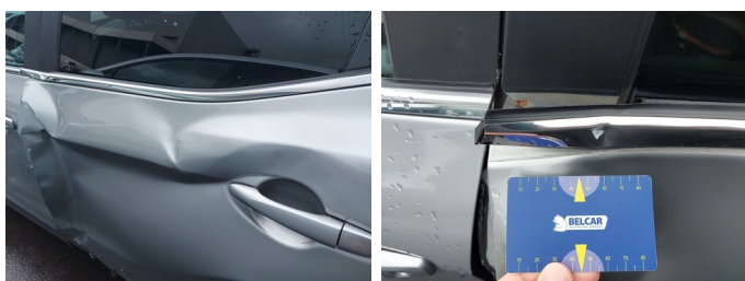
Deur LA - Sierlijst deur LA - Kras en Deuk - Vervangen
