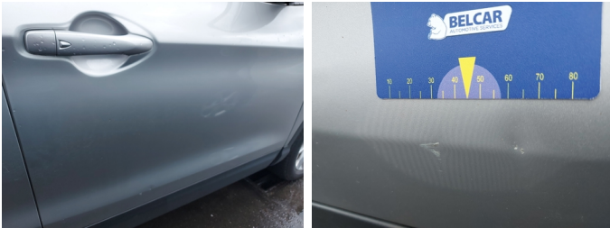
Deur RV - Deur RV - Kras en Deuk - Herstellen en spuiten
