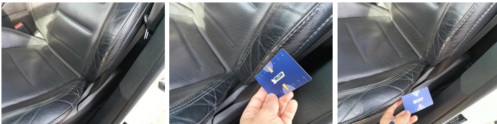
Zetels - Bekleding rug LV - Versleten - Vervangen
