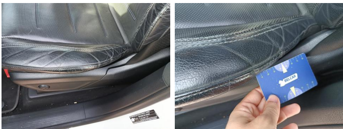
Zetels - Bekleding zit LV - Versleten - Vervangen
