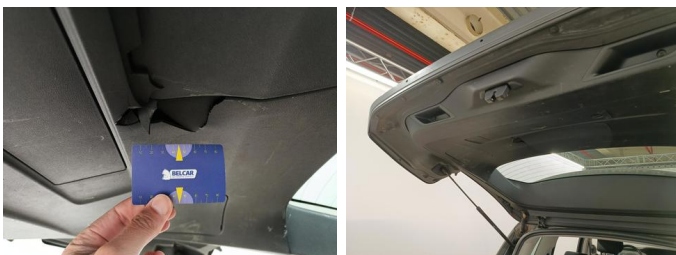
INT achteraan - Bekleding kofferdeksel - Gebarsten - Vervangen
