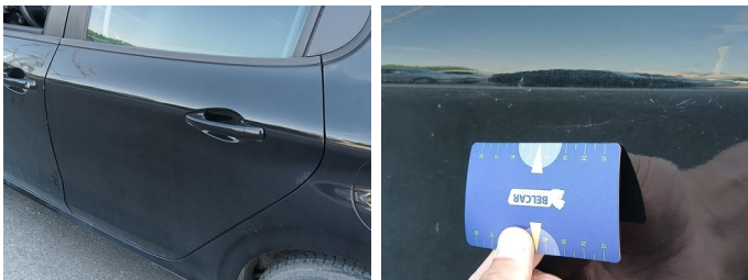
Deur LA - Deur LA - Kras - Spuiten
