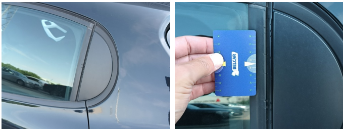
Deur LA - Afdichtingsrubber LA (Deurkader) - N comf / defect - Vervangen
