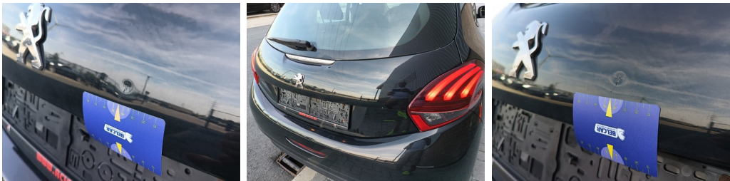
Koffer - Kofferdeksel - Kras en Deuk - Herstellen en spuiten
