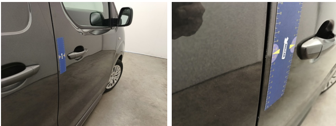
Deur RV - Deur RV - Kras - Touch-up
