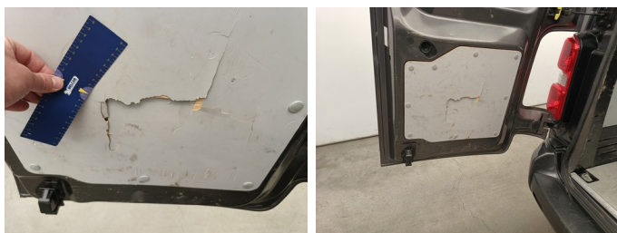
INT achteraan - Bekleding laaddeur L - Gebarsten - Vervangen
