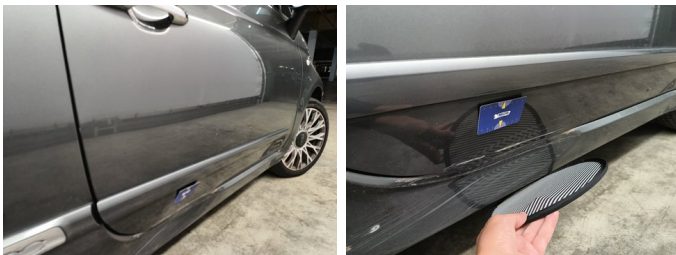
Deur RV - Deur RV - Kras en Deuk - Herstellen en spuiten
