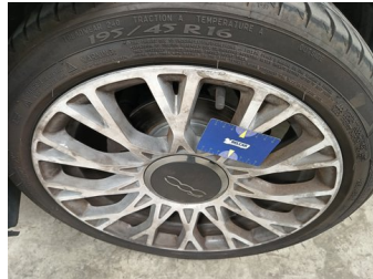
Wiel LV - Diamondcut velg LV - Chemische reactie - Sr-velgen diamandcut
