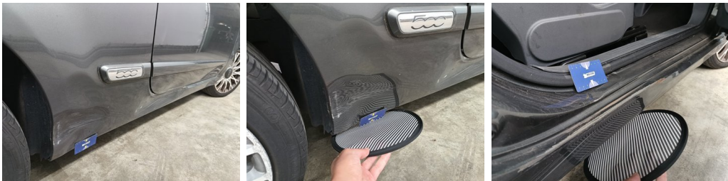
Onderkant R - Drempel R - Kras en Deuk - Herstellen en spuiten
