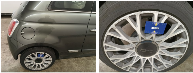
Vleugel RA - Vleugel RA - Kras en Deuk - Herstellen en spuiten
