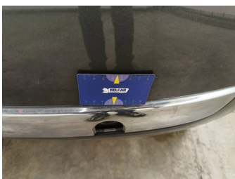
Bumper Achter - Afdekkap bumper achter - Ontbreekt - Vervangen
