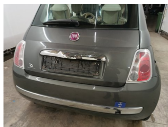
Bumper Achter - Afdekkap bumper achter - Ontbreekt - Vervangen
