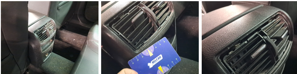
INT Vooraan / Midden - Verluuchtingsrooster achter - Gebarsten - Vervangen
