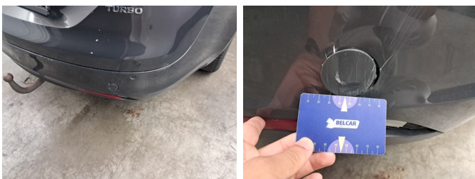
Bumper Achter - Afdekkap bumper achter - Gebarsten - Vervangen en spuiten
