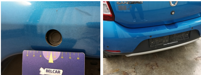
Bumper Achter - Parkeersensor achter - N comf / defect - Vervangen
