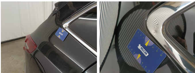
Vleugel RA - Sierlijst RA - Deuk - Vervangen
