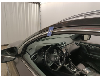
Deur LV - Sierlijst deur LV - Deuk - Vervangen
