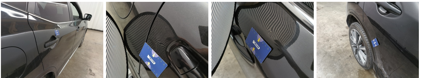
Deur RA - Deur RA - Kras en Deuk - Herstellen en spuiten
