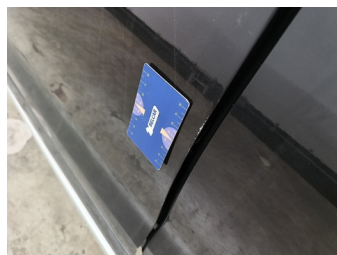
Deur LV - Sierlijst deur LV - Deuk - Vervangen
