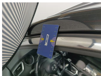
Deur LV - Sierlijst deur LV - Deuk - Vervangen
