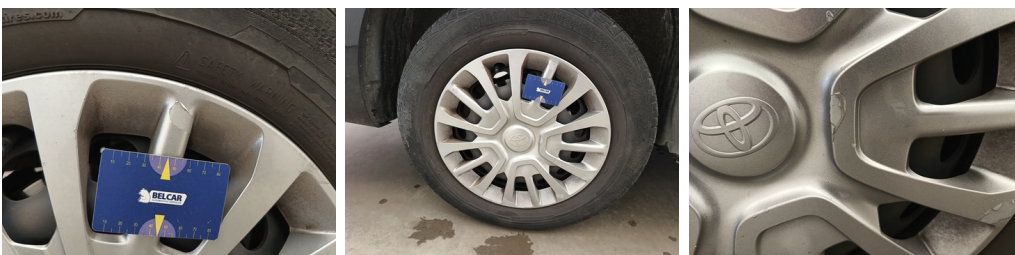
Wiel RA - Wieldeksel RA - Chemische reactie - Vervangen
